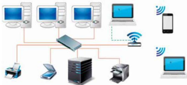
Схема типичной компьютерной сети
